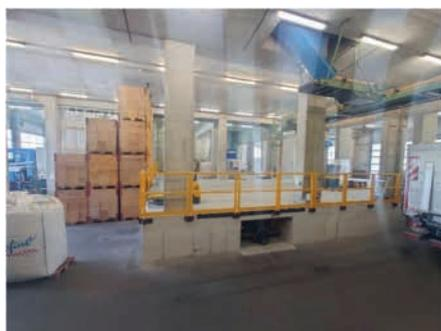
Die Aufgabe der Paloxen und der Big Bags erfolgt mittels einer Rollbahn, die mit Bremsrollen ausgestattet sind. So können bis zu fünf Paloxen oder Big Bags aufgegeben werden. Diese können dann mit dem Gegengewichtsstapler entnommen werden und rollen automatisch bis zum Anschlagpunkt weiter.
